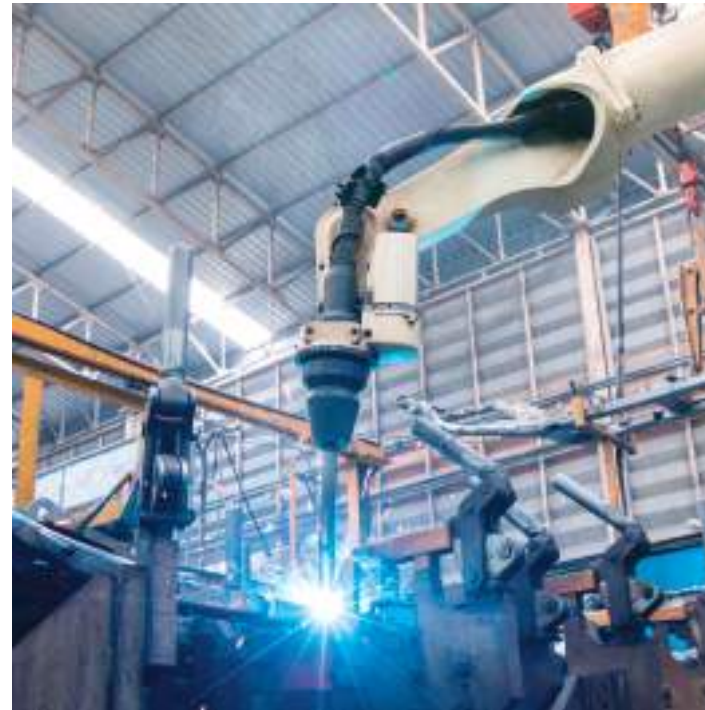
Soldadura robot Soudure robotisée
